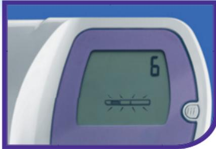
Das Testsymbol blinkt, während der Monitor ein Teststäbchen auswertet
