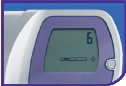
Das Display zeigt an, dass der Monitor ein Teststäbchen anfordert
